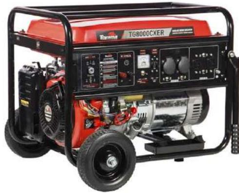
Diseñado para uso frecuente. Cuenta con un alternador síncrono monofásico de doble voltaje (115/230 V) con selector, de 2 polos, con una potencia máxima de 7,2 kVA, excitador rotativo con escobillas y regulador automático de voltaje (AVR).
