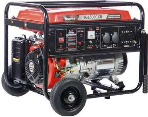
Diseñado para uso frecuente. Cuenta con un alternador síncrono monofásico de doble voltaje (115/230 V) con selector, de 2 polos, con una potencia máxima de 6,0 kVA, excitador rotativo con escobillas y regulador automático de voltaje (AVR).
