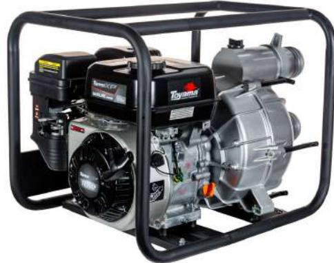
La bomba de basura autocebante Toyama TWP80T-XP fue desarrollada para uso profesional. Está equipado con un motor de gasolina de máxima potencia de 7 hp con arranque manual. Fabricado con materiales de alta resistencia y durabilidad, tiene un cuerpo de aluminio con un diámetro de succión de 3" y un diámetro de descarga de 3". El rotor y la voluta están fabricados en hierro fundido. Dispone de un marco tubular que protege el conjunto y facilita el transporte.
