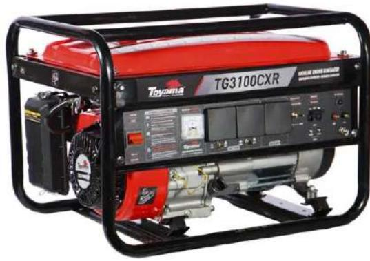
Diseñado para uso frecuente. Cuenta con un alternador síncrono monofásico bivoltaje de 115/230 V con selector, de 2 polos, con una potencia máxima de 3,1 kVA, excitador rotativo con escobillas y regulador automático de voltaje (AVR). Su estructura es robusta.
