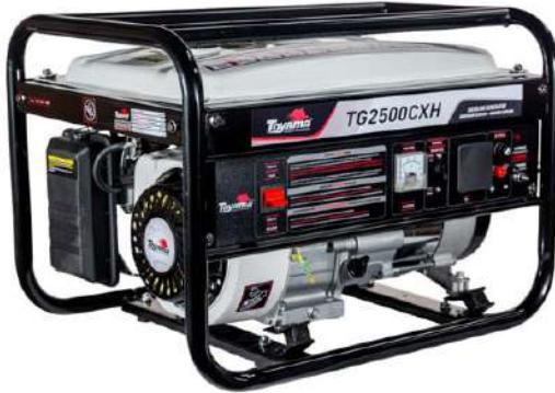
Diseñado para uso ocasional. Cuenta con un alternador síncrono monofásico de 127 V y 2 polos con una potencia máxima de 2,2 kVA, excitador rotativo con escobillas y un regulador automático de voltaje (AVR).
