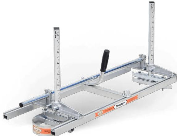
El marco para aserrar ME4706-0102 es un accesorio de aluminio diseñado para convertir una motosierra en un sistema de corte longitudinal preciso. Su estructura ligera pero resistente permite obtener tablones y piezas de madera con acabados uniformes, ideal para trabajo en campo, proyectos de carpintería portátil o producción en zonas remotas. Es un equipo pensado para usuarios que necesitan movilidad, precisión y durabilidad, sin depender de un aserradero tradicional.
