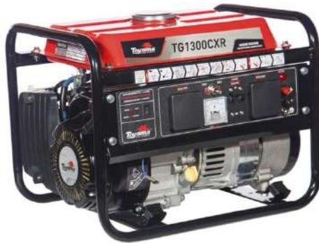
El generador bivoltaje Toyama TG1300CXR fue diseñado para uso frecuente. Cuenta con un alternador síncrono monofásico bivoltaje de 115/230 V con selector, de 2 polos, con una potencia máxima de 1,25 kVA, excitador rotativo con escobillas y regulador automático de voltaje (AVR).
