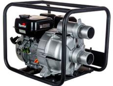
La bomba de basura autocebante Toyama TOTWP80T-XP, fue desarrollada para uso profesional. Está equipado con un motor de gasolina de máxima potencia de 7 hp con arranque manual. Fabricado con materiales de alta resistencia y durabilidad, tiene un cuerpo de aluminio con un diámetro de succión de 3" y un diámetro de descarga de 3". El rotor y la voluta están fabricados en hierro fundido. Dispone de un marco tubular que protege el conjunto y facilita el transporte.
